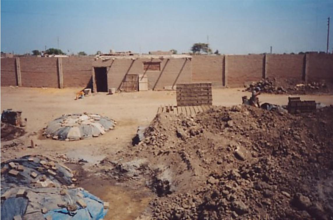
**Foto 2:** Proceso de elaboración de la mezcla en el ladrillo informal
