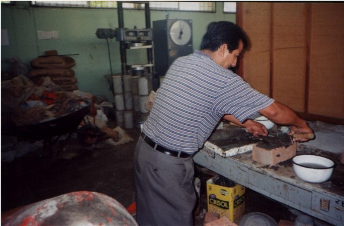
**FOTO 8. Ladrillo aplicándole una carga a compresión**
